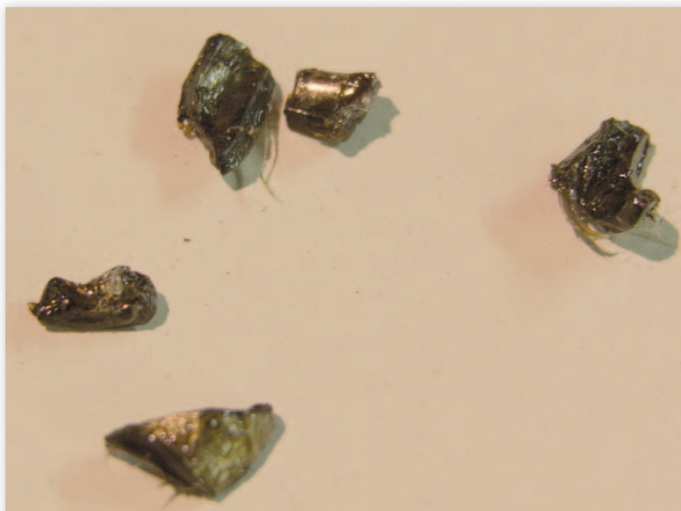
Rys. 7 Elementy uszkodzonej Dyszy GK
