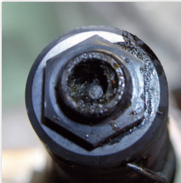
Rys. 6 Uszkodzona Dysza GK
